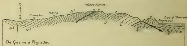
FIG. 57. — Coupe de la Mokra de Çesme à Pogradec, de l'ouest à l'est.
